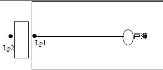
图 4-4 室内声源等效为室外声源图例
