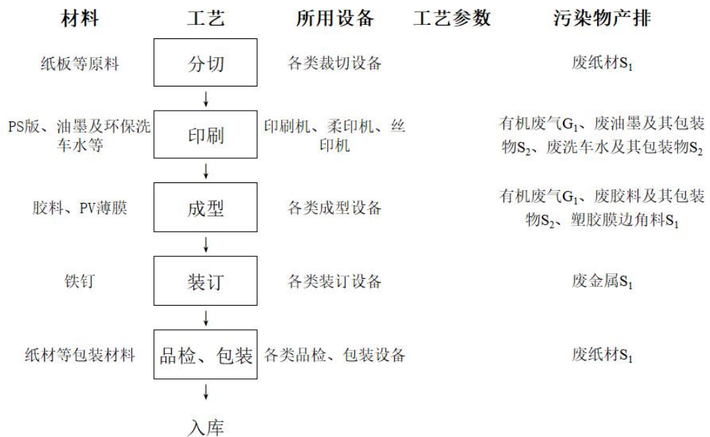
图 2 印刷生产工艺流程图
