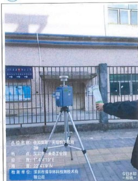
厂界外无组织废气下风向 3#检测点
