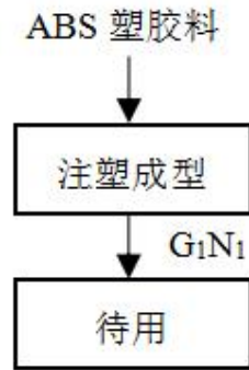
图 2-2 项目塑胶制品生产工艺流程图
