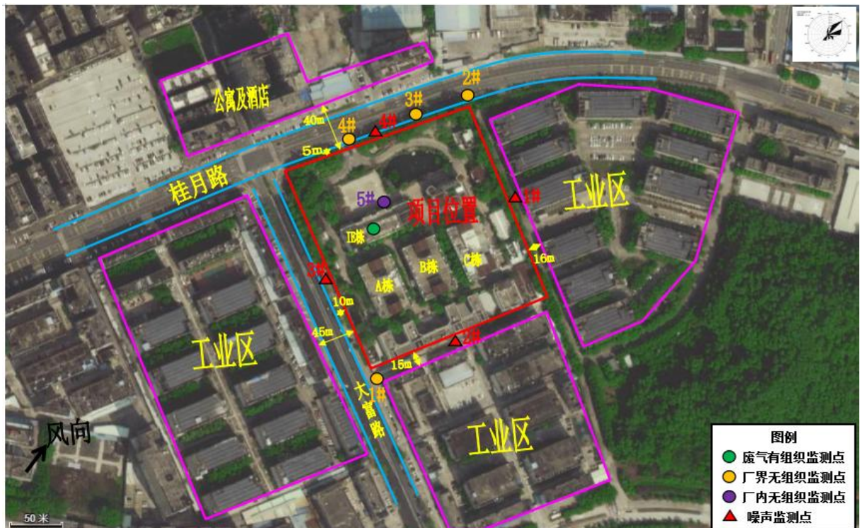
图 2-1 项目地理位置及噪声、废气检测点位图
