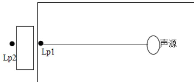
图 7-1 室内声源等效为室外声源图例
