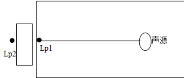
图 12 室内声源等效为室外声源图例
